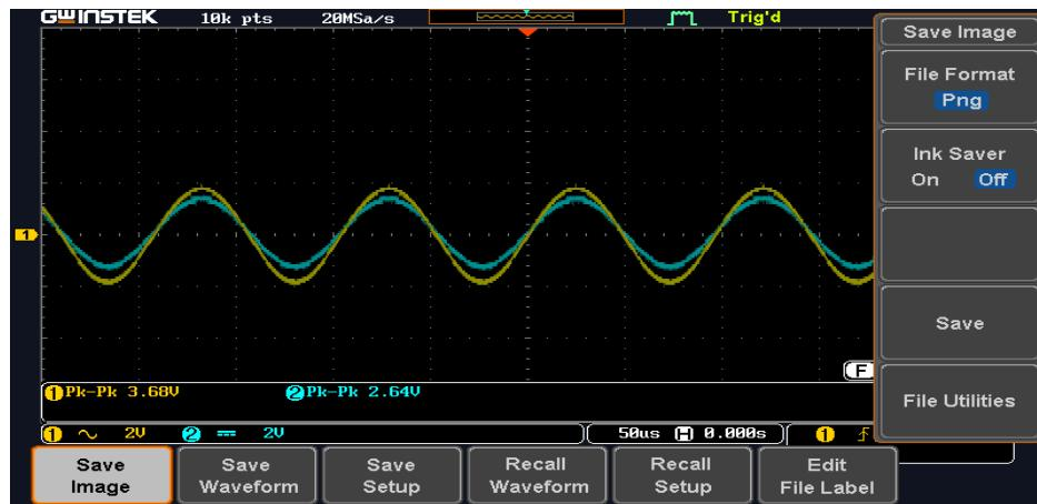
Slika 5.14. Ulagani i izlazni napon pri ulaznoj amplitudi  $U_{ulm} = 1.5$  V
