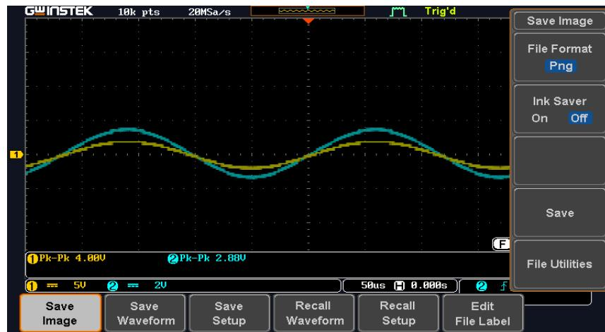
Slika 5.11. Ulagni i izlazni napon pri ulaznoj amplitudi  $U_{ulm} = 2$  V
