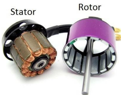
Slika 3.5. Outrunner istosmjerni motor bez četkica
