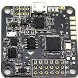
Slika 3.14. Pločica za kontrolu leta NAZE32 Rev5
