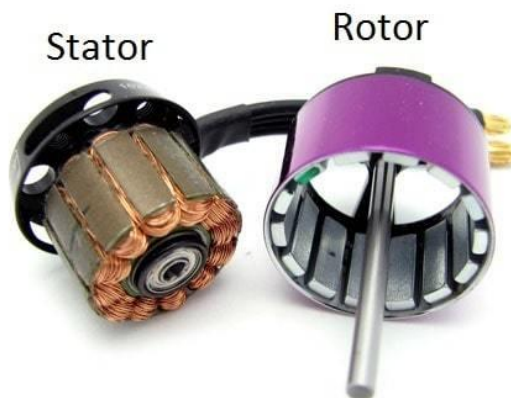
Slika 3.5. Outrunner istosmjerni motor bez četkica
