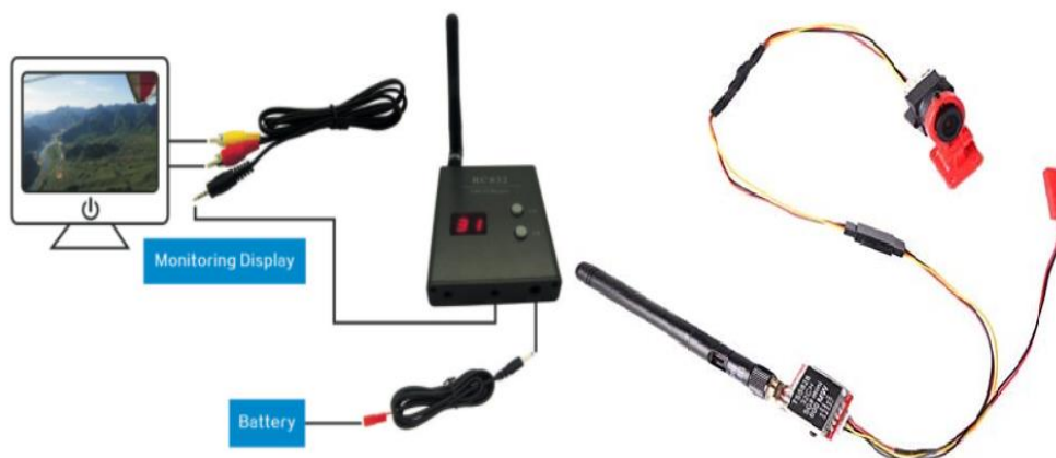
Slika 6.4. Pojednostavljena shema spoja FPV opreme
