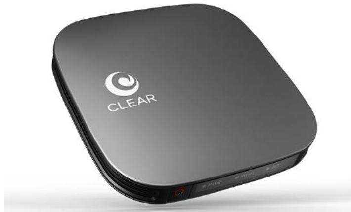
Slika 5.3. Mobilni WiMAX hotspot tvrtke CLEAR [10]
