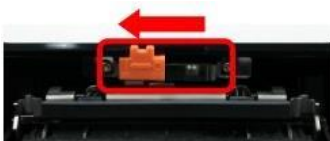
Slika 3.7. Postavljanje prekidača na lijevu stranu
