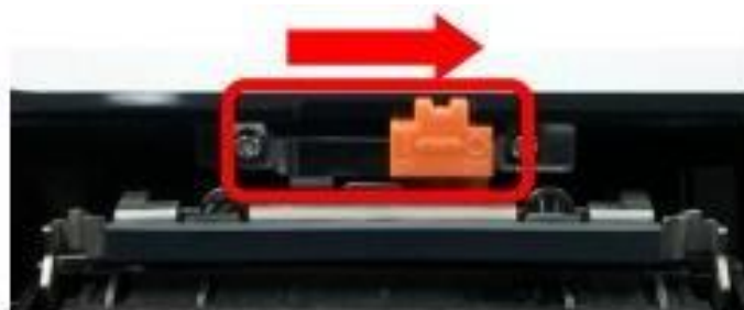
Slika 3.8. Postavljanje prekidača na desnu stranu
