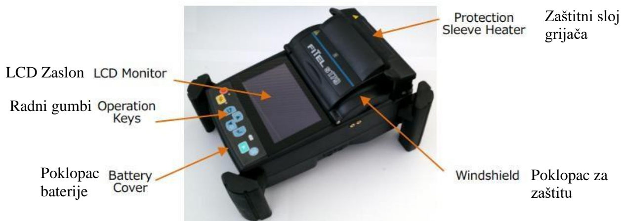
Slika 3.2. Dijelovi spajача optičkih niti
