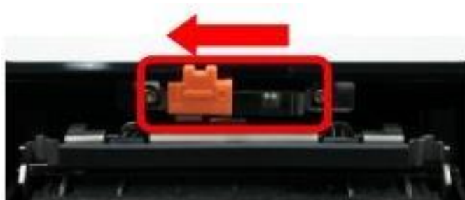
Slika 3.7. Postavljanje prekidača na lijevu stranu
