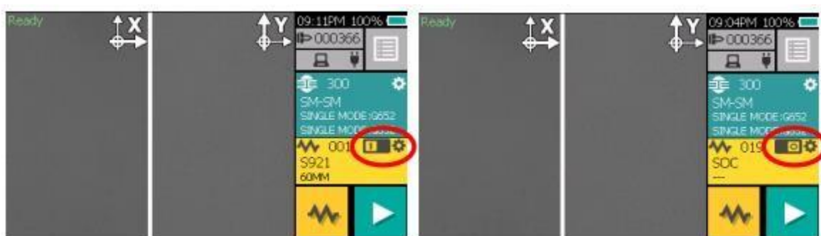
Slika 3.6. Paljenje i gašenje grijača
