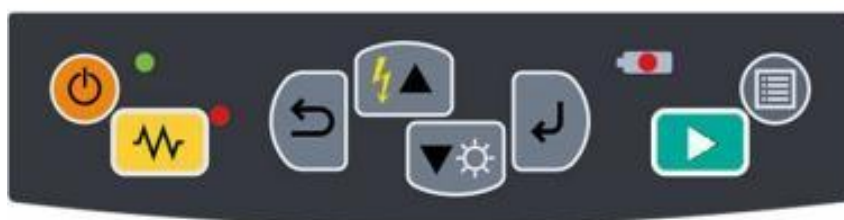
Slika 3.5. Radni gumbi spajača optičkih niti
