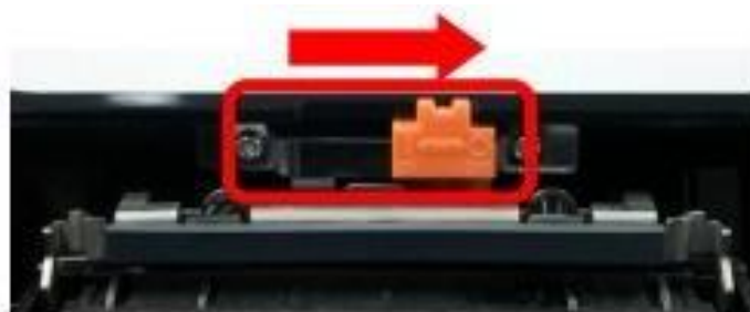
Slika 3.8. Postavljanje prekidača na desnu stranu
