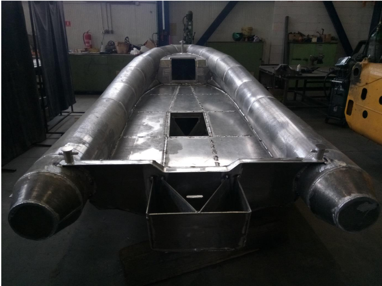
Slika 3.8 U cijelosti zavaren brod [1]
