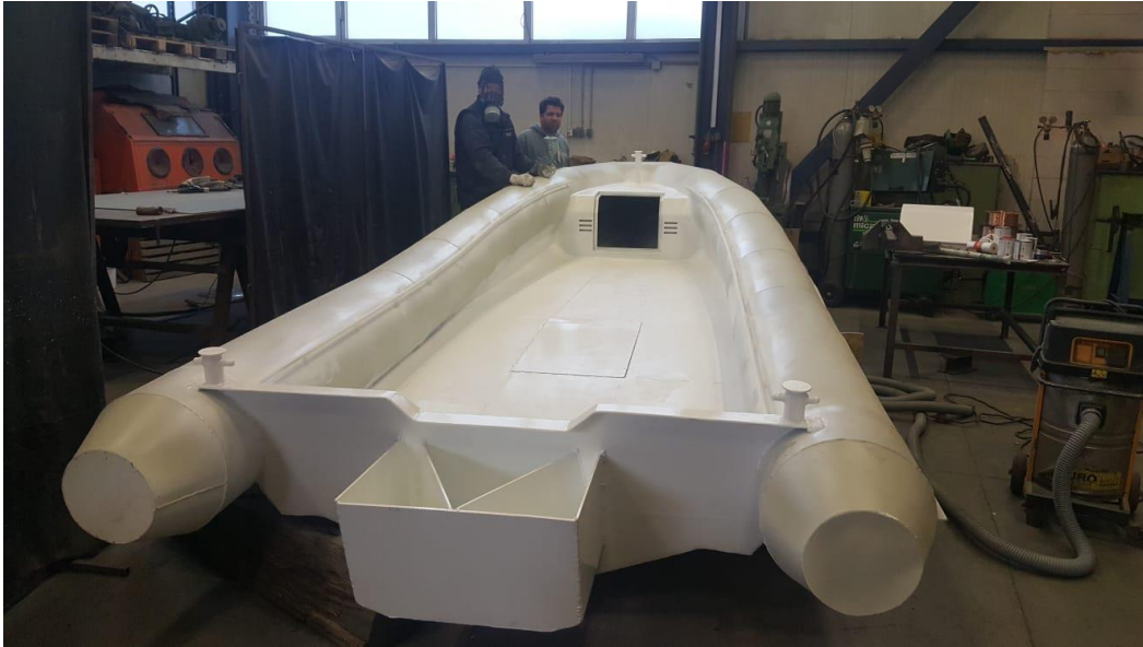
Slika 3.10 Nanošenje "primer" premaza [1]
