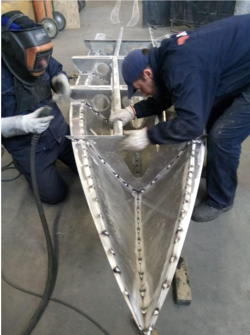
Slika 3.7 Pripajanje limova trupa uz rebra [1]
