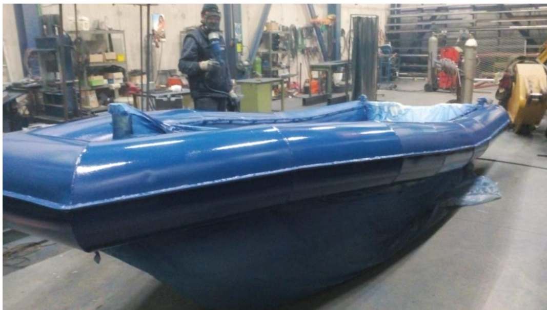
Slika 3.11 Nanošenje podvodne zaštite i završnog premaza [1]
