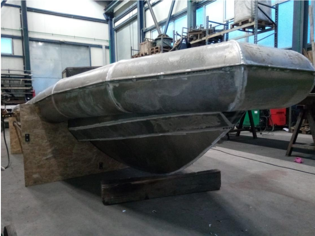
Slika 3.9 Zavarena konstrukcija prije brušenja [1]
