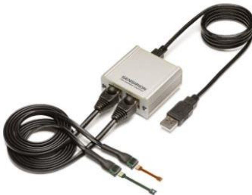
Slika 3.27 - Kombinirani osjetnici temperature i vlage spojeni na uređaj za povezivanje s računalom [18]
