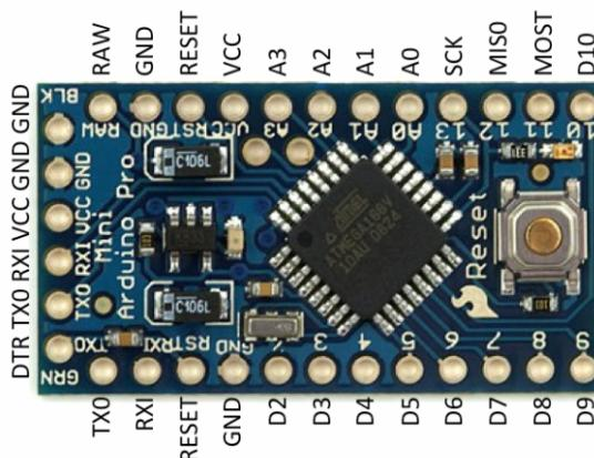
*Slika 4.3. Arduino Pro Mini – prikaz pinova [15]*
