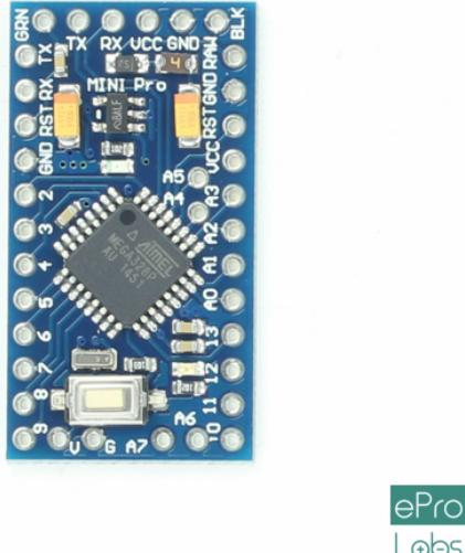
*Slika 4.2. Arduino Pro Mini mikrokontroler [15]*
