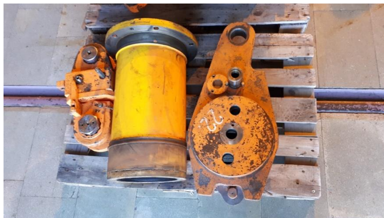
Slika 4. 27. Sastavni dijelovi mehanizma lopatice [15]
