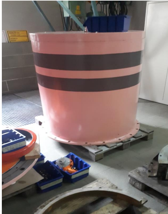
Slika 4. 3. Poklopac uljnog razvodnik [15]
