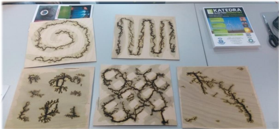
Slika 5.3 Propagacija električnog stabla kroz materijal
