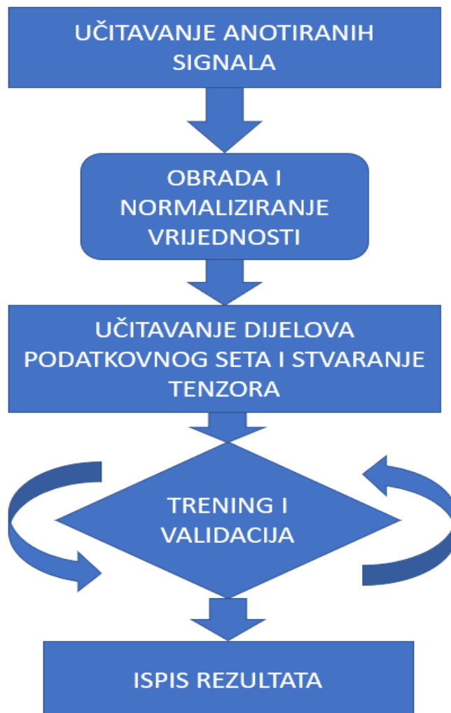
Slika 8.1 Radni dijagram toka programa za detekciju PI
