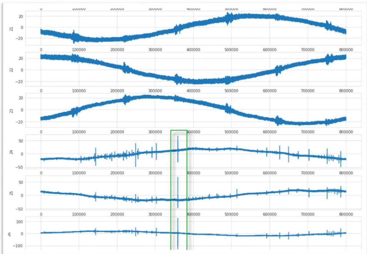
Slika 6.7 PI dijelovi sinusoide mjerenih kabela [7]
