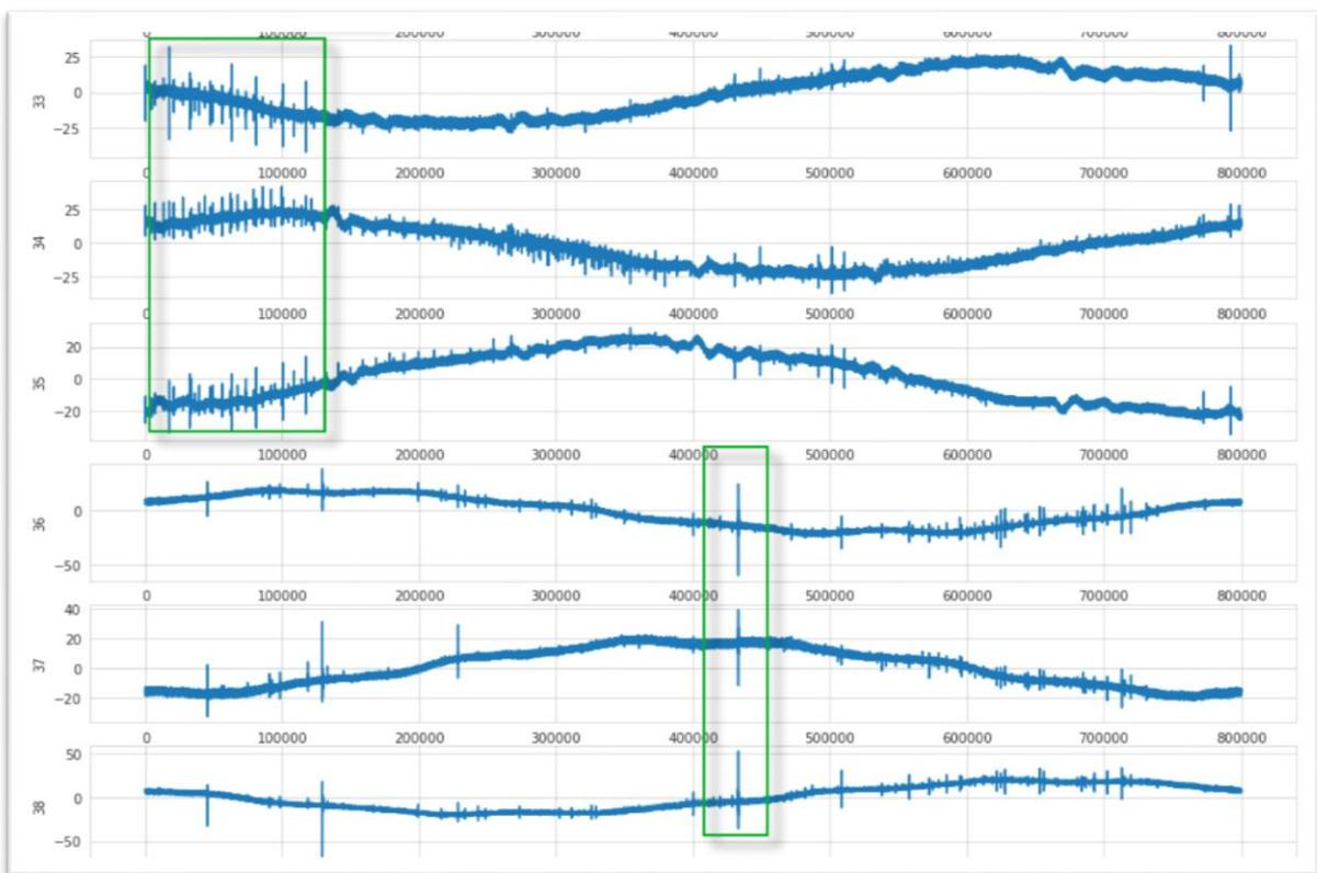
Slika 6.9 PI dijelovi sinusoide mjerenih kabela [7]
