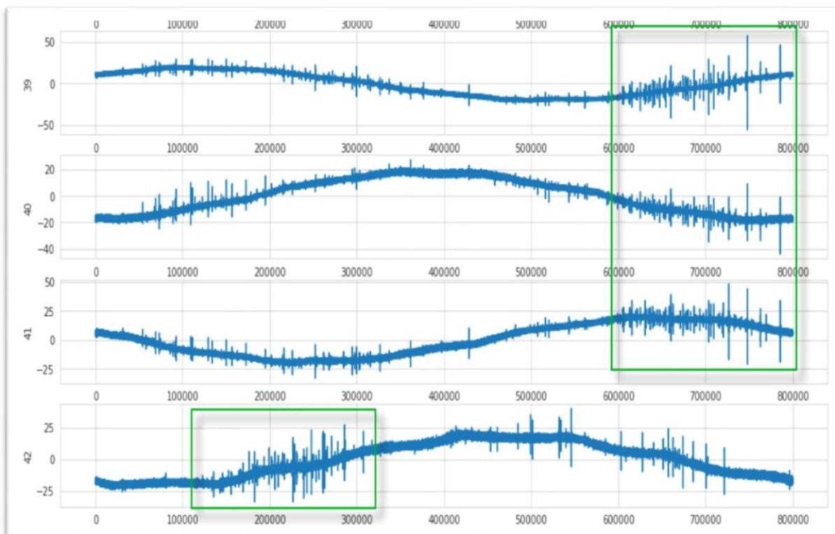
*Slika 6.11 PI dijelovi sinusoide mjerenih kabela [7]*
