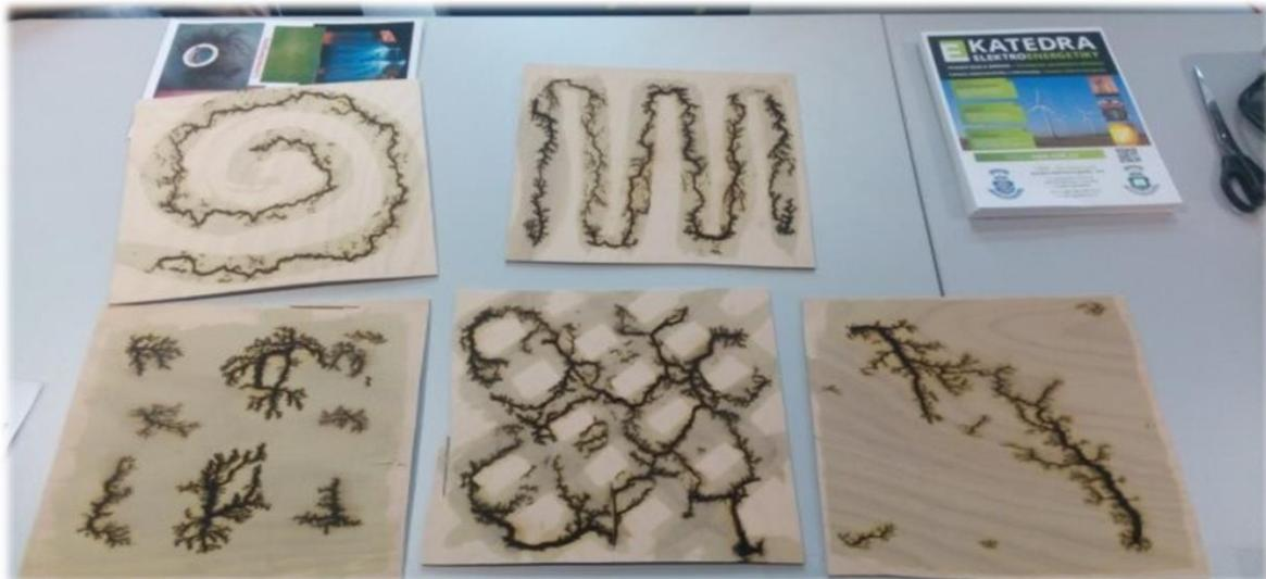
*Slika 5.3 Propagacija električnog stabla kroz materijal*
