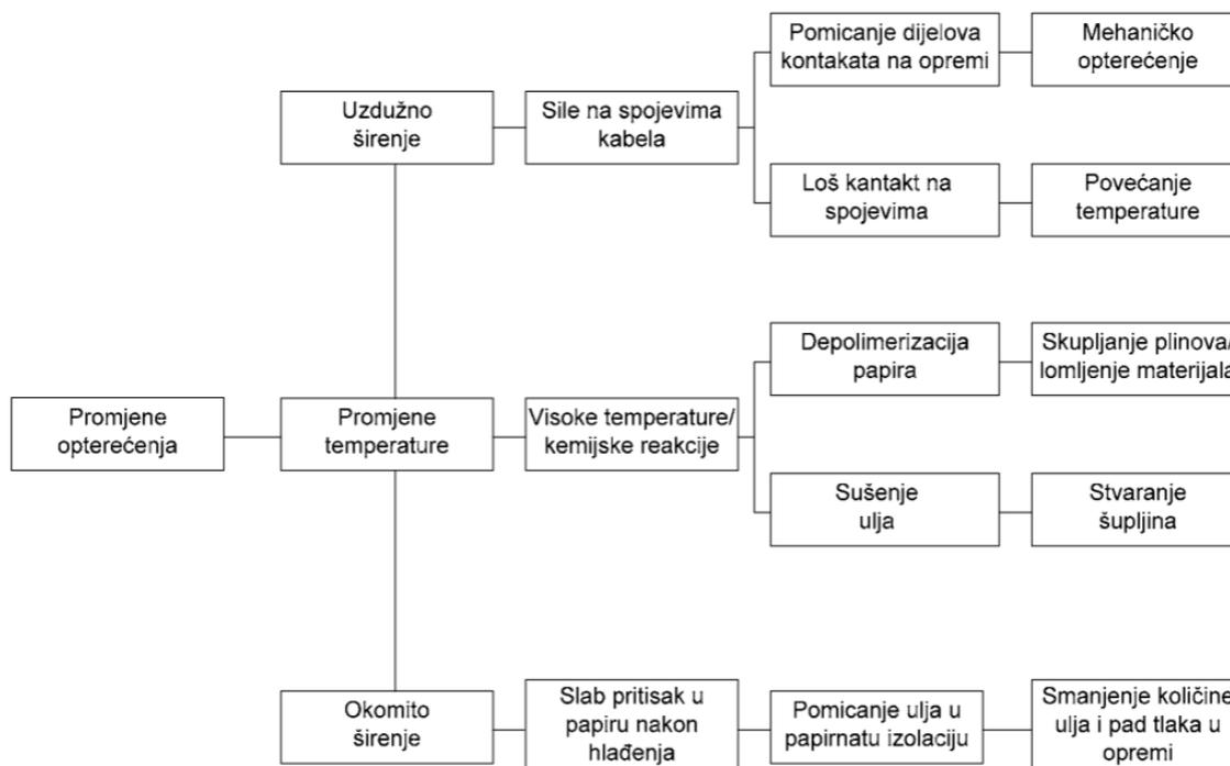
Slika 3.2 Pregled pogonskih naprezanja i uzrokovanih kvarova [1]
