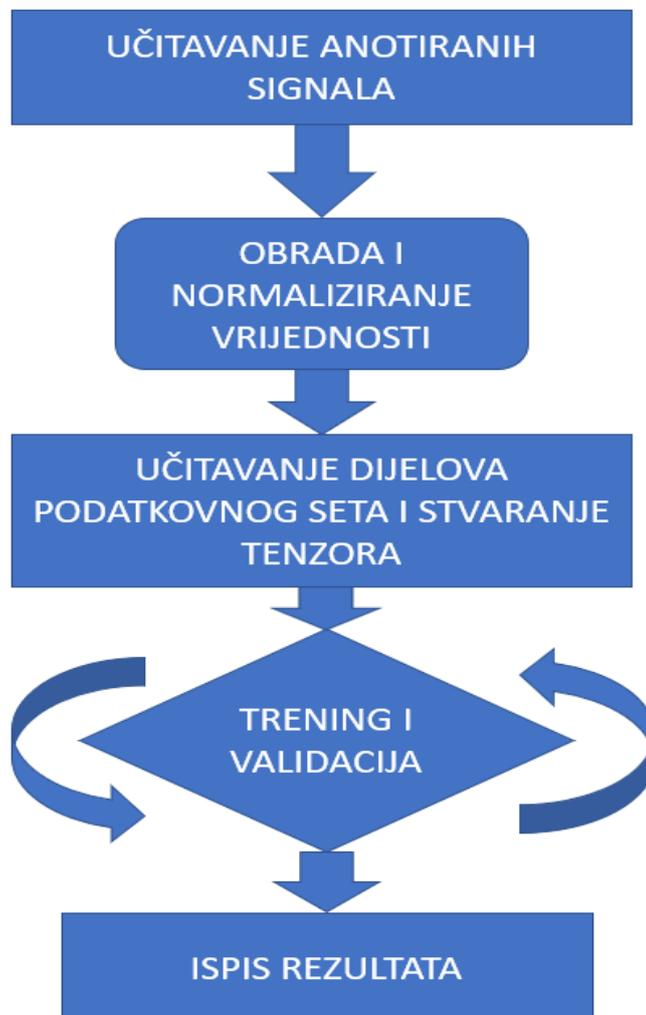
Slika 8.1 Radni dijagram toka programa za detekciju PI
