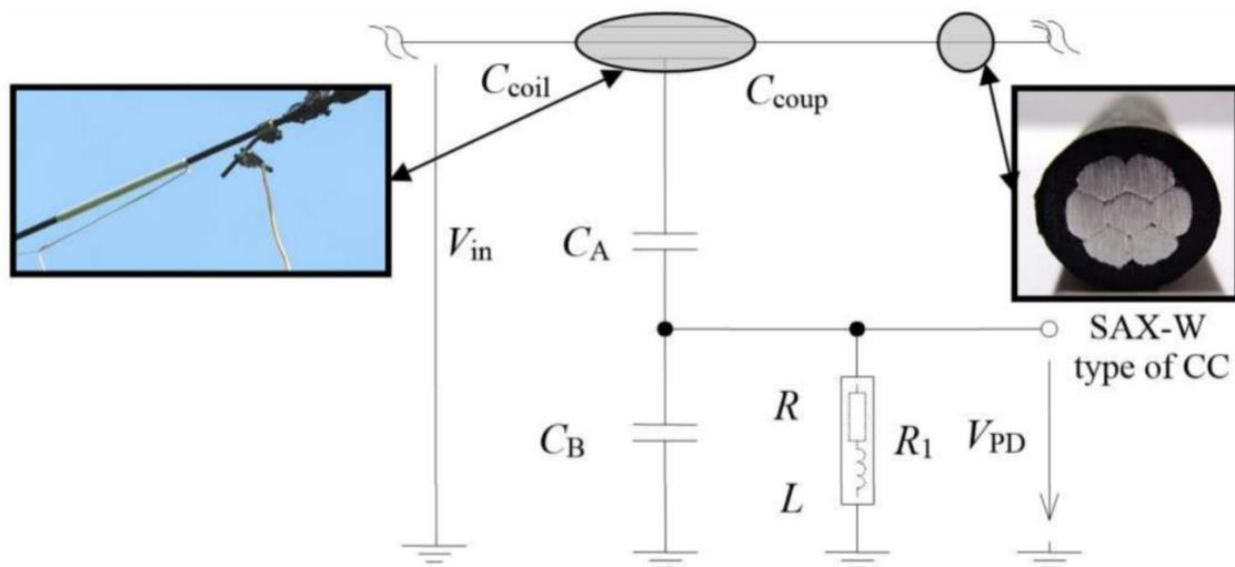
Slika 6.1 Shema uređaja za snimanje impulsne komponente napona uključujući niskopropusni filter [10]
