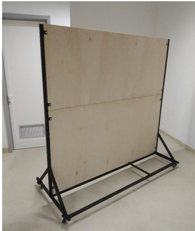
Slika 5.31 - Okvir modela sa pričvršćenom pločom
