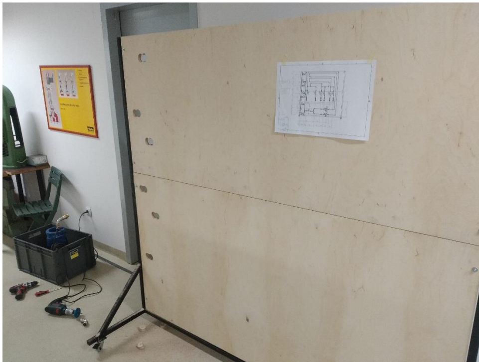
Slika 5.32 - Ploča s provrtima za prolaz elemenata
