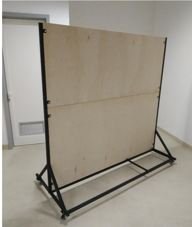
Slika 5.31 - Okvir modela sa pričvršćenom pločom
