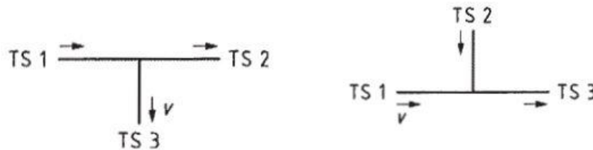
Slika 4.1 - Označavanje t komada prema DIN 1988-300 [10]
