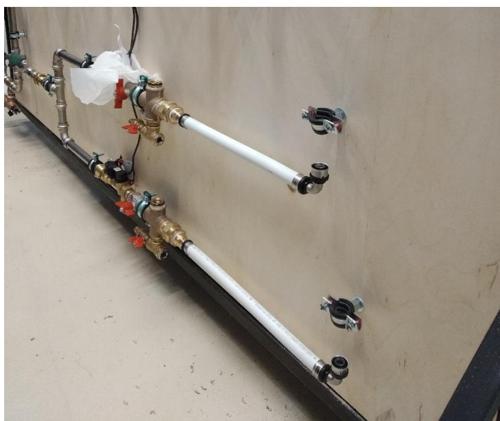
Slika 5.40 - Pozicioniranje obujmica promjenjivog dijela cjevovoda
