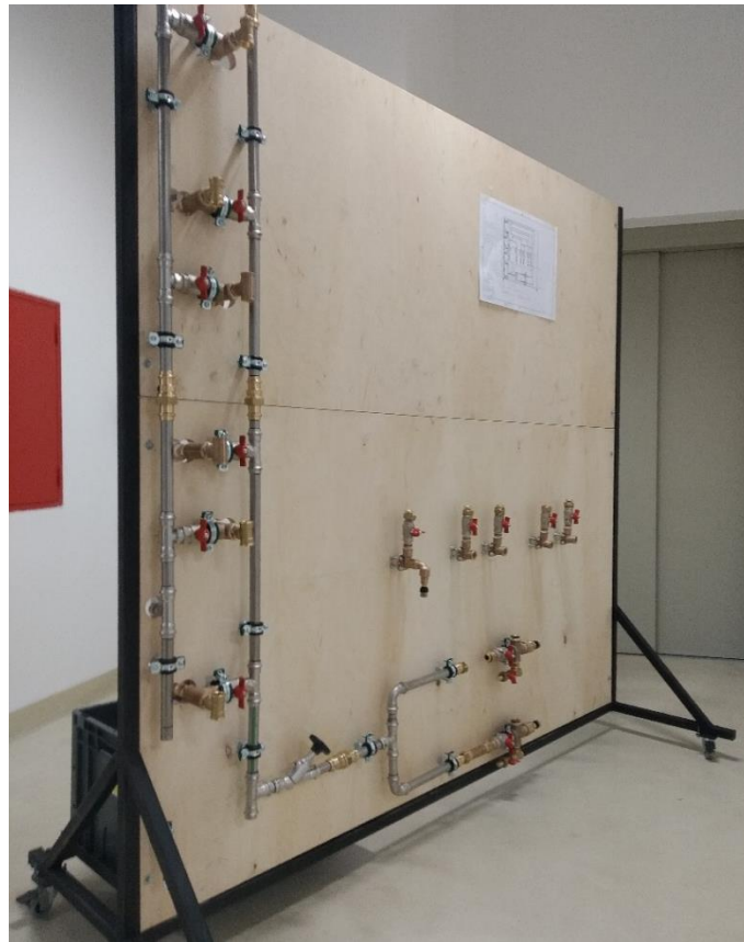
Slika 5.34 - Montaža elemenata, cijevi i obujmica
