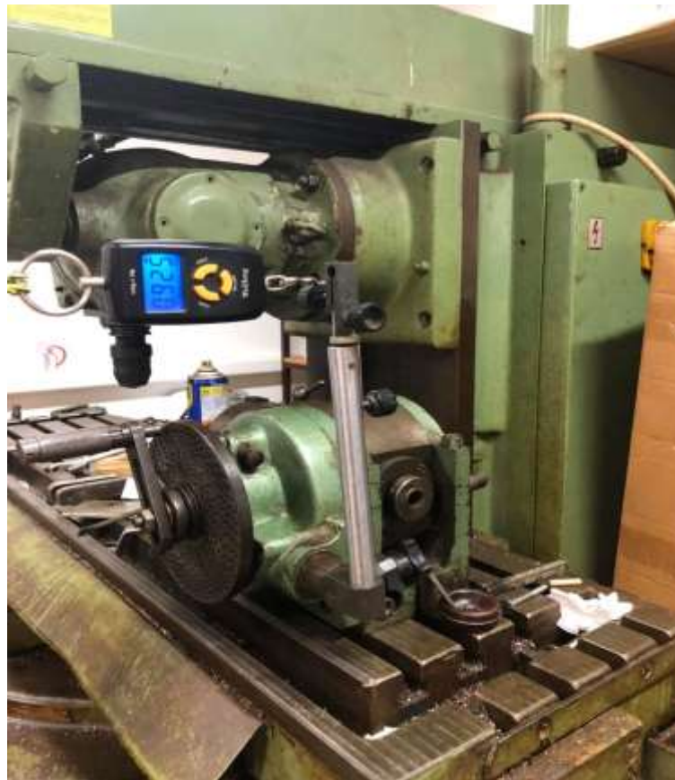
Slika 1.4 – Očitavanje težine za okretanje vratila
