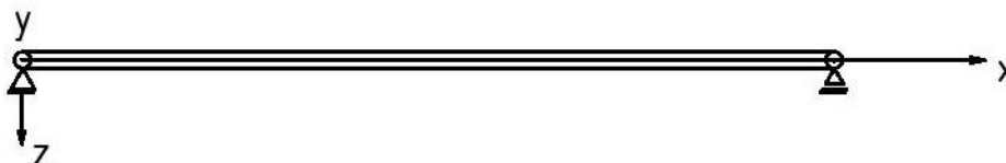
Slika 1.2 - Dogovorno definiran koordinatni sustav kod ravninskih linijskih nosača
