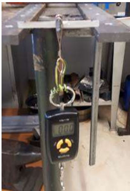
Slika 3.2 Ispitivanje vlačne čvrstoće uzorka bez vlakana
