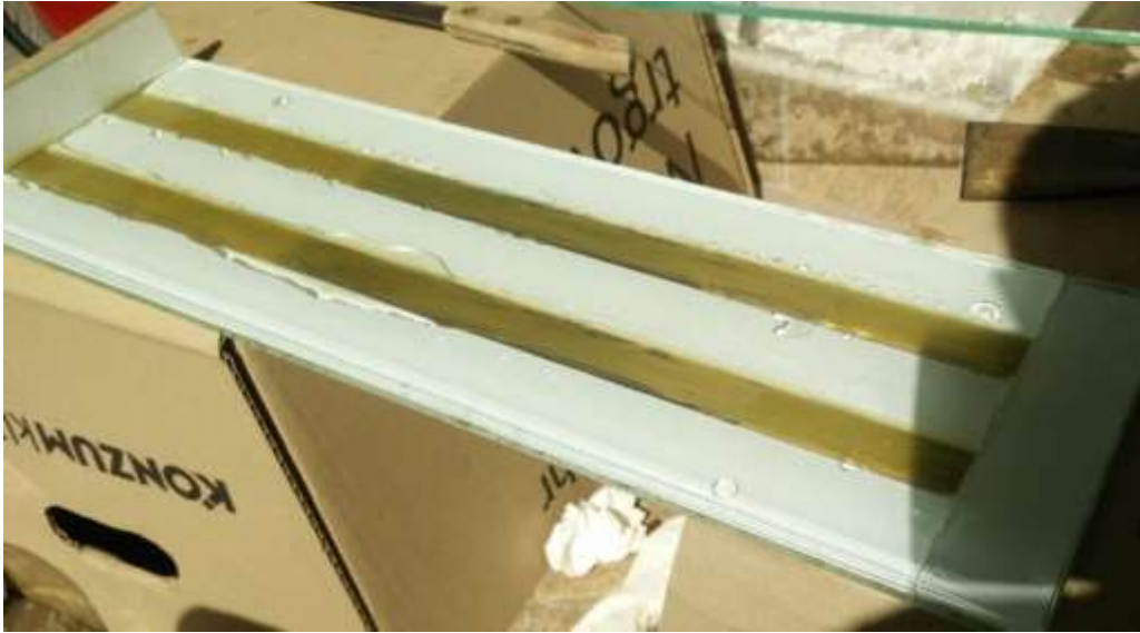
Slika 3.6 Kalup ispunjen smolom i vlaknima
