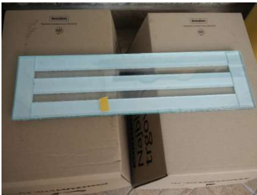
Slika 3.4 Stakleni kalup za izradu uzoraka
