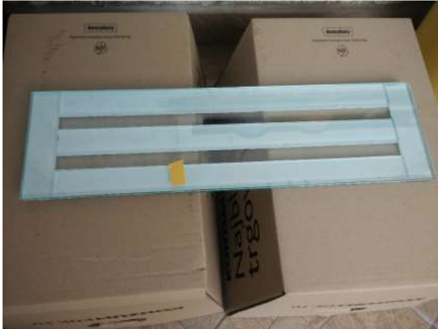
Slika 3.4 Stakleni kalup za izradu uzoraka
