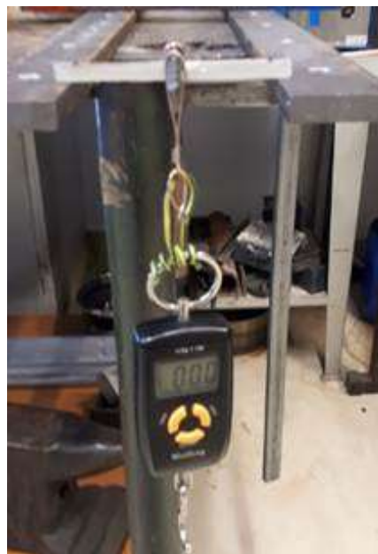
Slika 3.2 Ispitivanje vlačne čvrstoće uzorka bez vlakana
