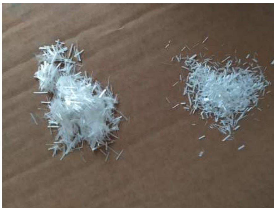
Slika 3.3 Staklena vlakna duljine 3 i 6 mm
