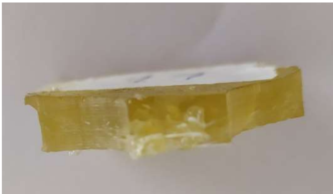
Slika 3.12 Presjek uzorka na mjestu loma
