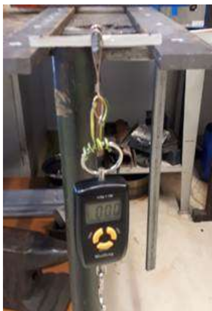
Slika 3.2 Ispitivanje vlačne čvrstoće uzorka bez vlakana
