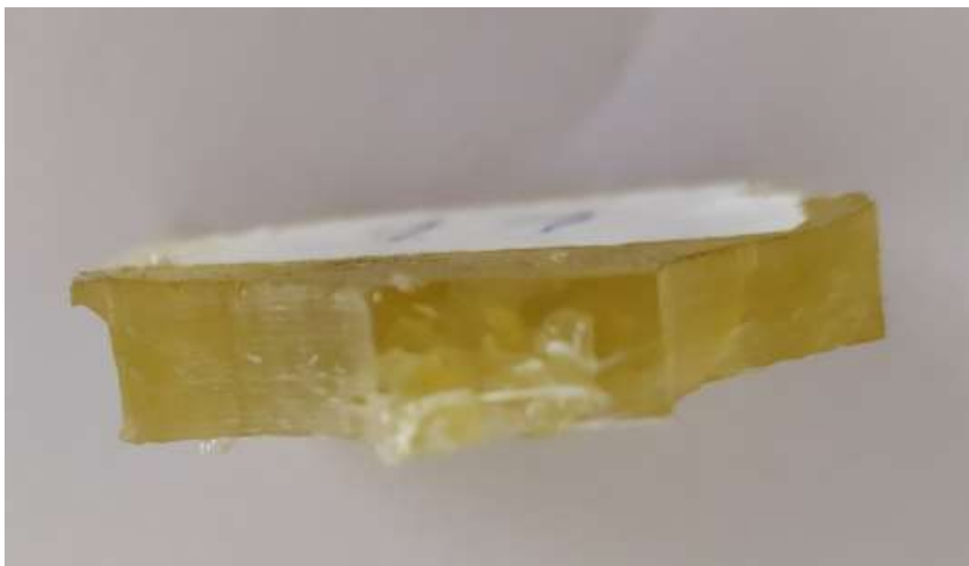
Slika 3.12 Presjek uzorka na mjestu loma
