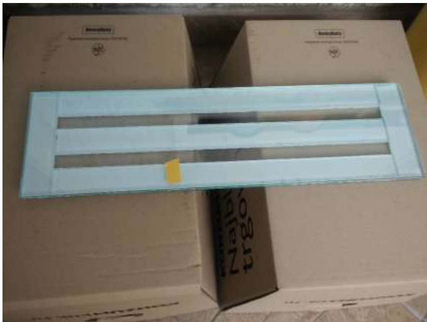
Slika 3.4 Stakleni kalup za izradu uzoraka
