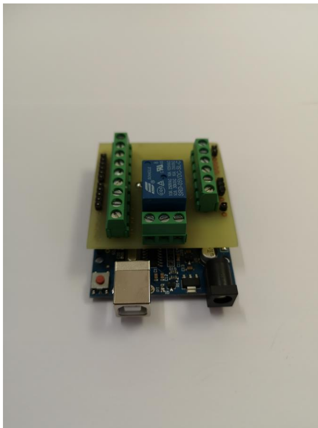
Slika 30 - Sučelje spojeno na Arduino Uno
