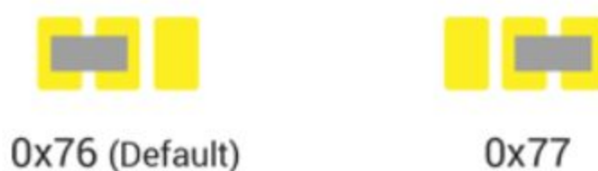
Slika 17. Prikaz mogućih I2C adresnih konfiguracija putem kratkospojnika
