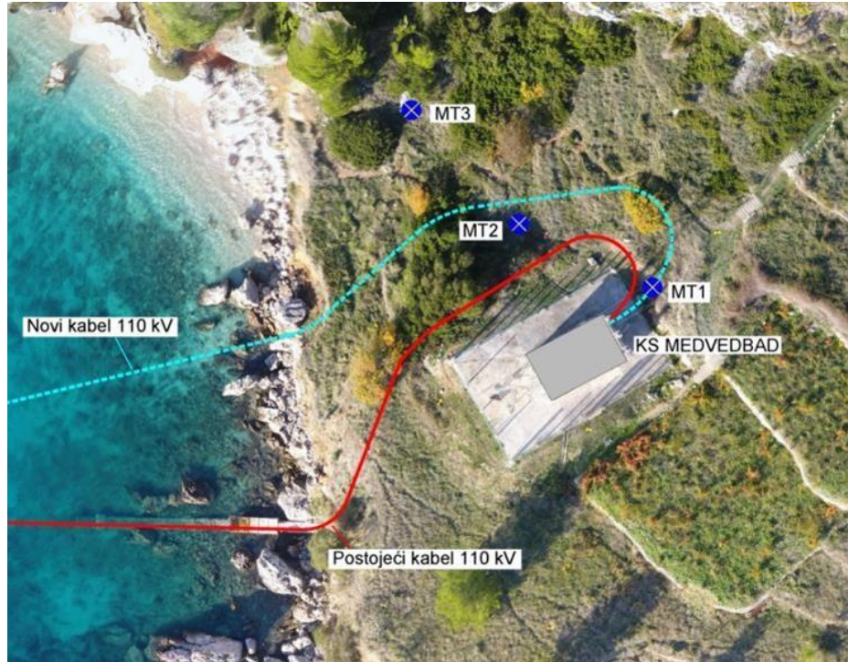
Slika 5.3 Položaj istražnih jama (MT1, MT2 i MT3) na lokaciji KS Medvidbad
