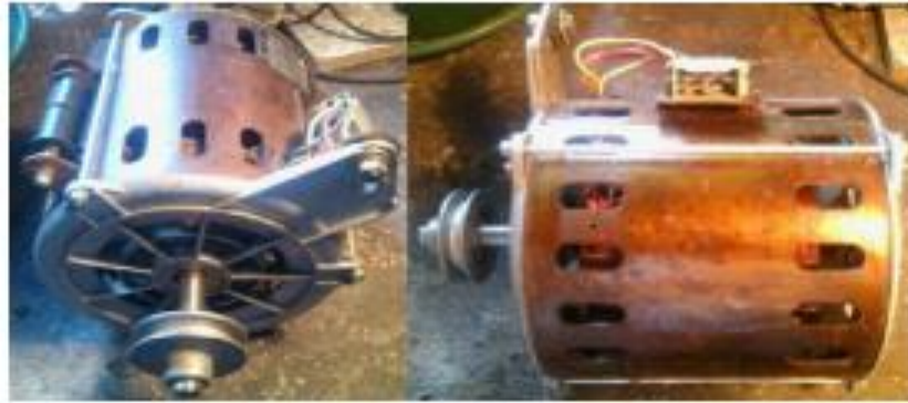
Slika 20. Izvedba motora u perilici rublja. [7]
