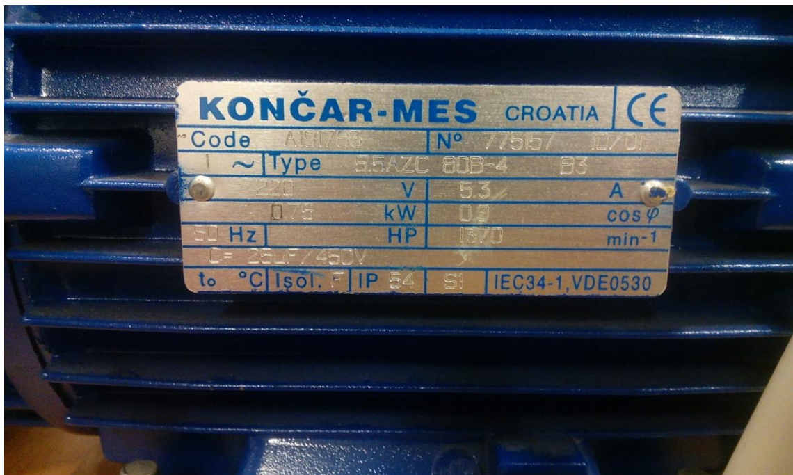
Slika 16. Natpisna pločica jednofaznog asinkronog motora koji je korišten u pokusu
