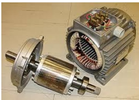
Slika 3. Kavezni motor sa rotorom izrađenim od aluminija. [6]
