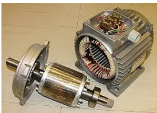
Slika 3. Kavezni motor sa rotorom izrađenim od aluminija. [6]
