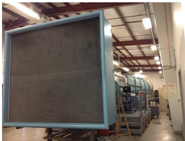
Slika 2.3.- Elementi za smirivanje strujanja u zračnom tunelu UC Davis [6]
