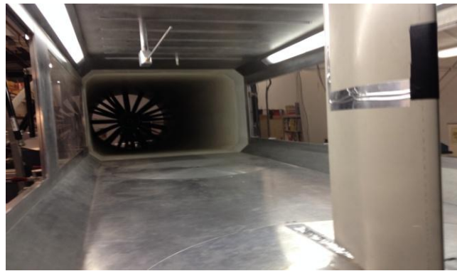
Slika 2.2.- Ispitni dio zračnog tunela „UC Davis Aeronautical Wind Tunnel“ [6]
