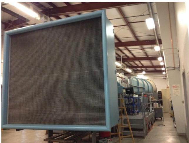
*Slika 2.3.- Elementi za smirivanje strujanja u zračnom tunelu UC Davis [6]*
