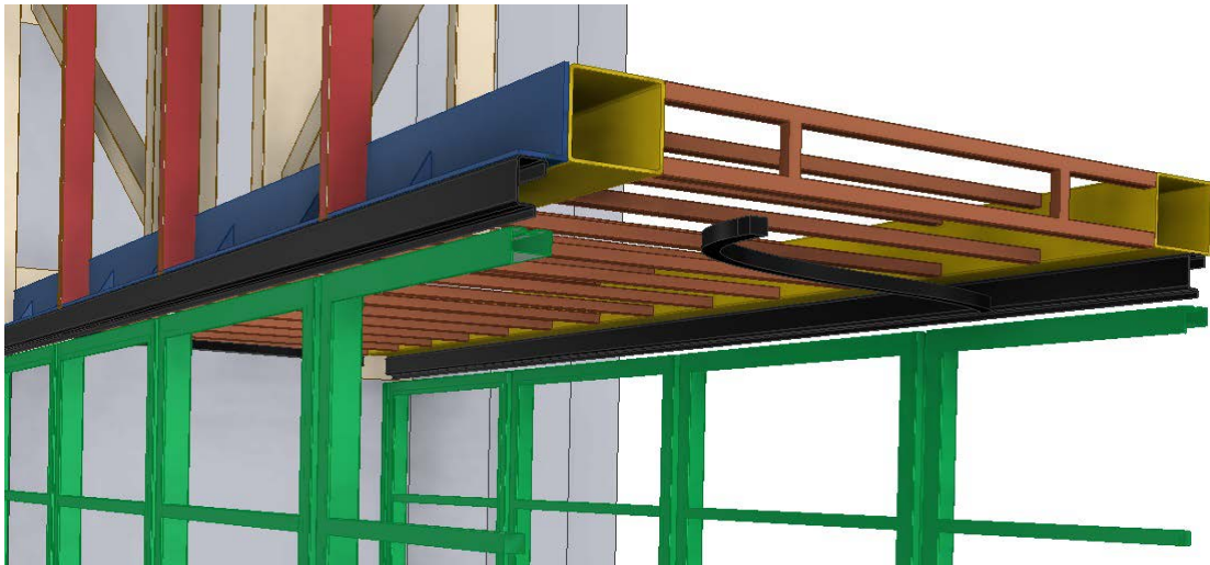
Slika 6.20 - Pomoćna konstrukcija glavnog nosača 1 [2]
