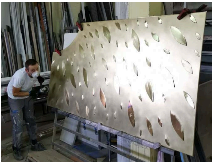
Slika 7.33 - Obrada segmenta vanjske dekorativne obloge sa izrezanim motivom maslinovog lista
