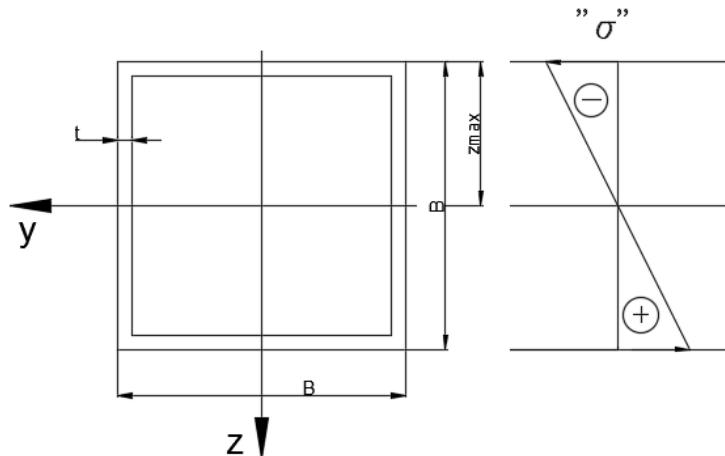
Slika 6.5 - Presjek profila glavnog nosača
