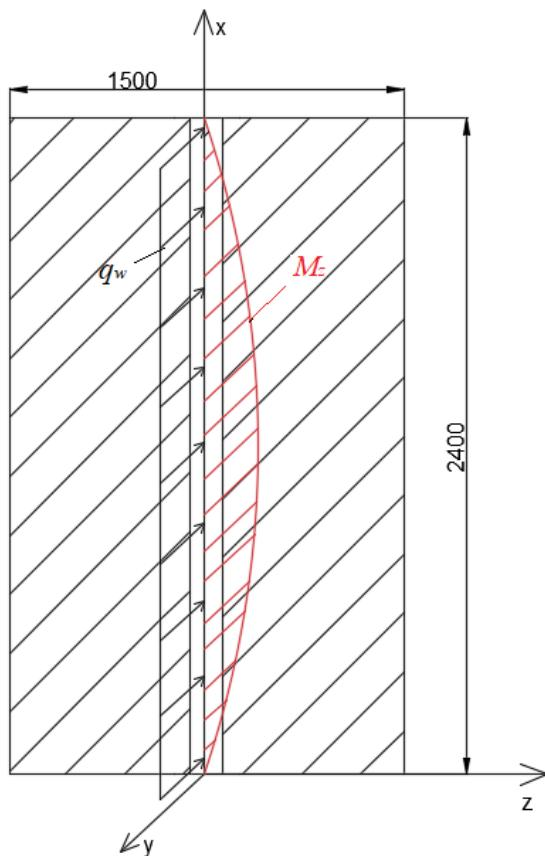
Slika 6.12 - Vertikalni vezni nosač opterećen vjetrom
