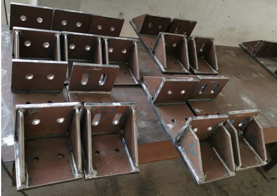
Slika 7.10 - Oslonci nosive konstrukcije u izradi
