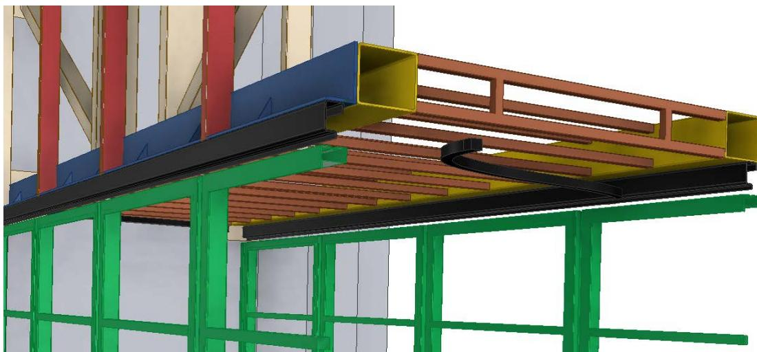
Slika 6.20 - Pomoćna konstrukcija glavnog nosača 1 [2]
