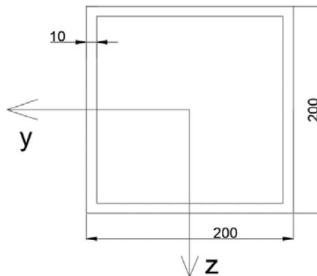
*Slika 6.10 - Dimenzije presjeka profila glavnog nosača*
