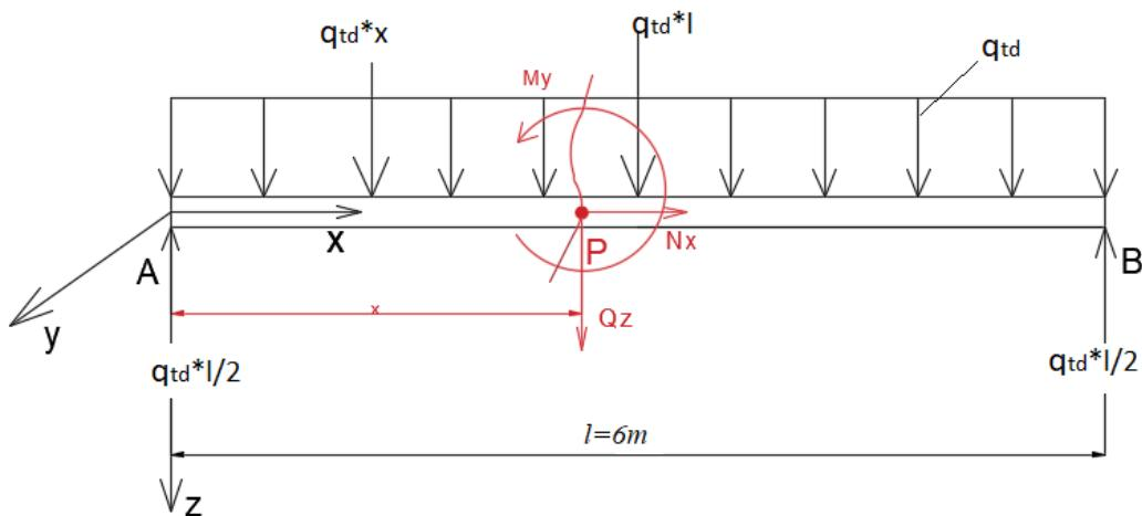
Slika 6.11 - Unutrašnje sile presjeka na udaljenosti x
