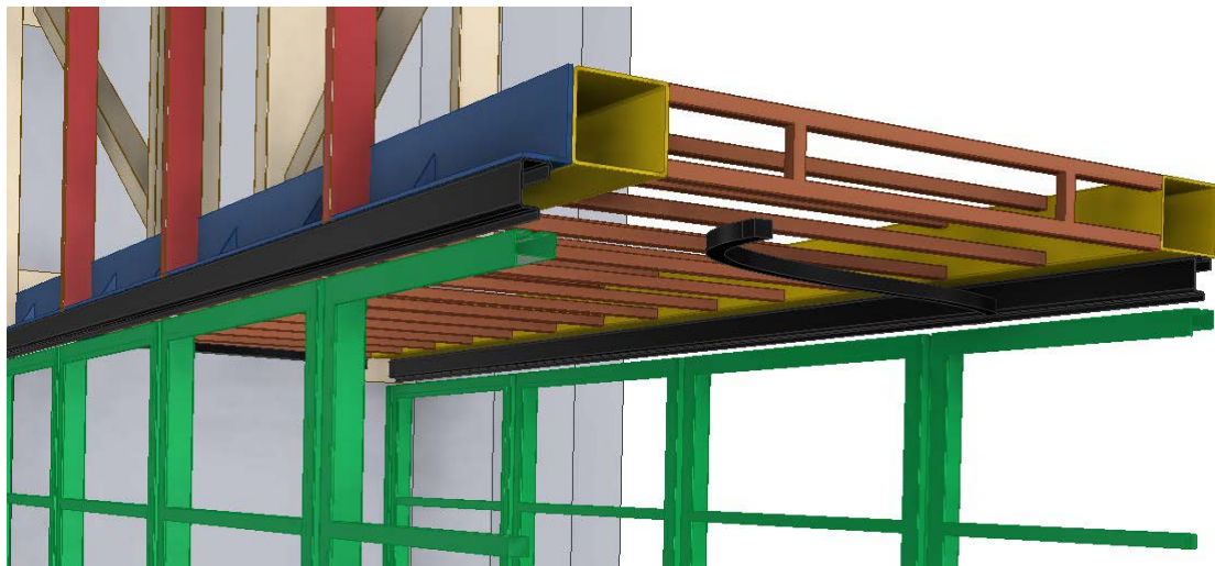
Slika 6.20 - Pomoćna konstrukcija glavnog nosača 1 [2]
