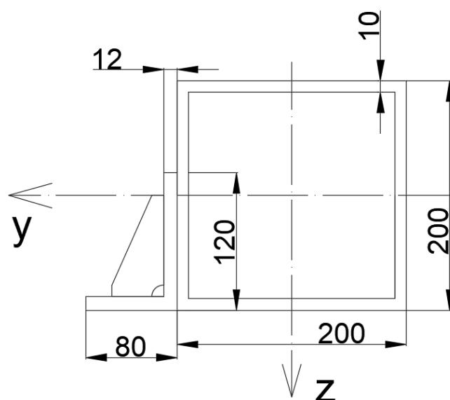
Slika 6.15 - Presjek profila glavnog nosača 1 sa L ukrutom
