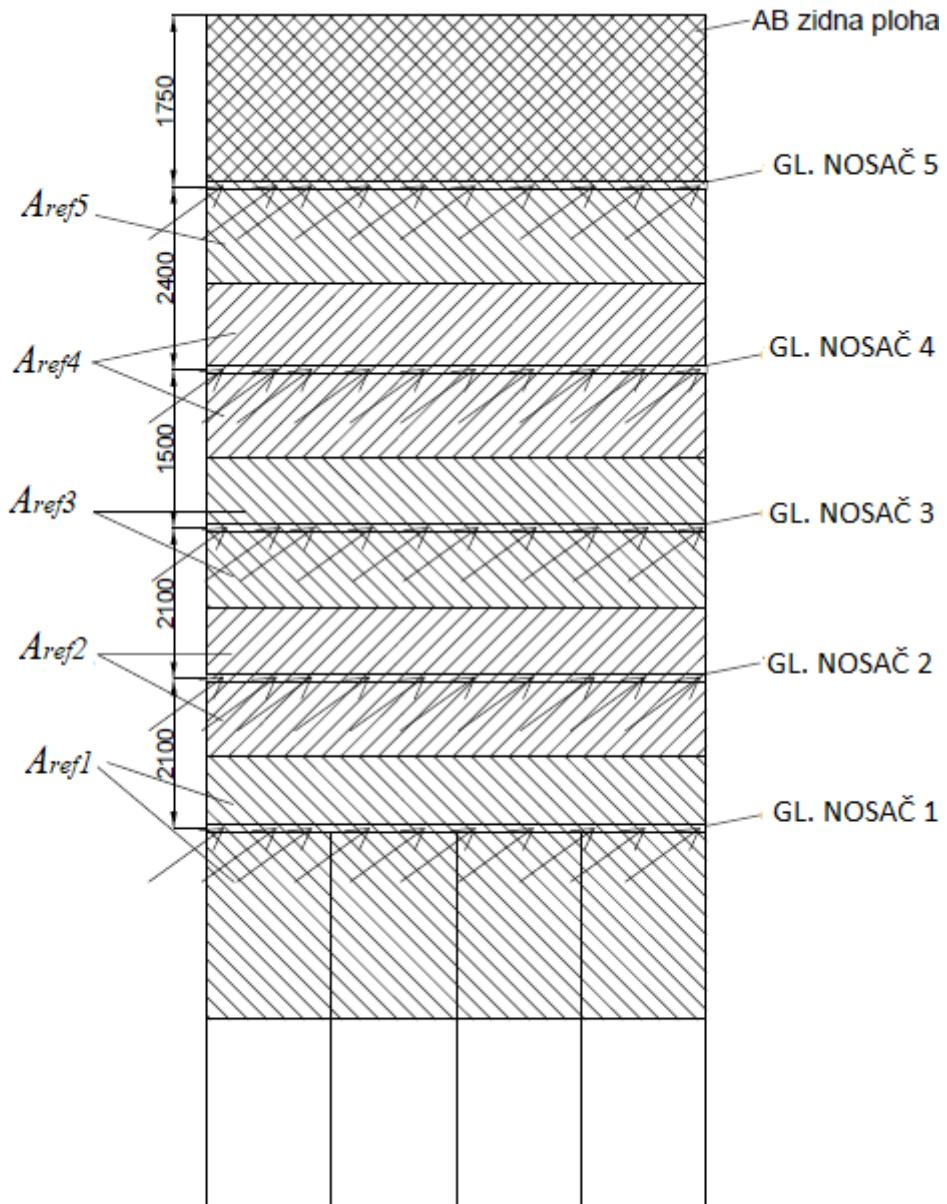
Slika 6.19 - Podjela konstrukcije na referentne površine opterećene vjetrom
