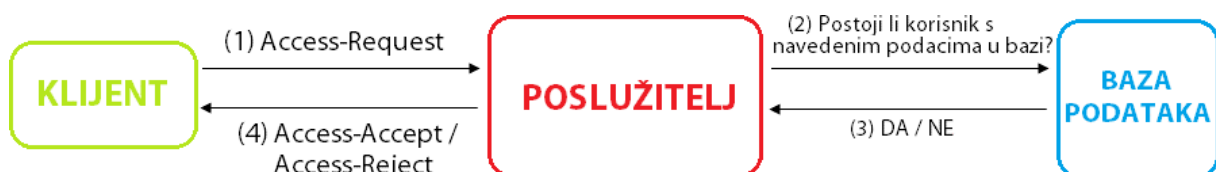
Slika 3. Tijek razmjene RADIUS poruka[3]
