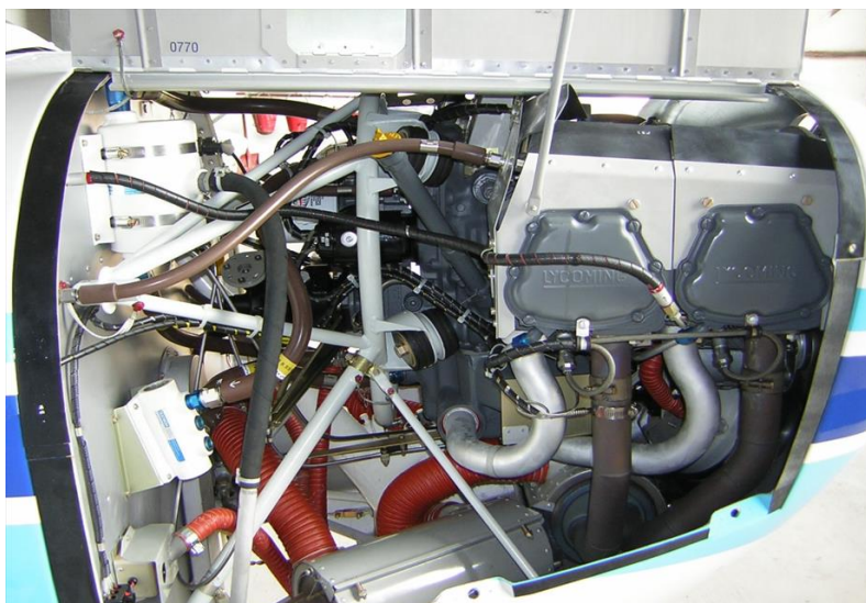
Slika 6.10. Zorniji prikaz motora zrakoplova Zlin 242L [18]
