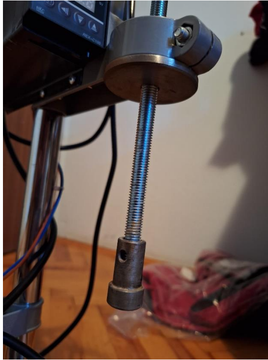
Slika 2.5 – Čep za centriranje klipa i klip na uređaju
