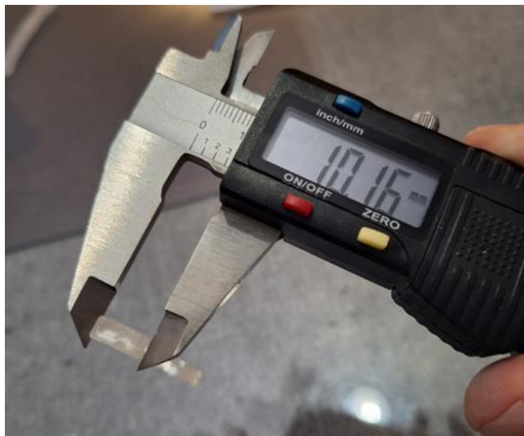
Slika 5.9 – Mjerenje visine uzorka
