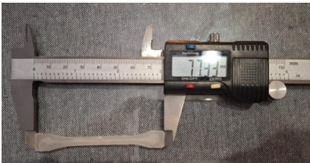
Slika 5.7 – Mjerenje duljine uzorka
