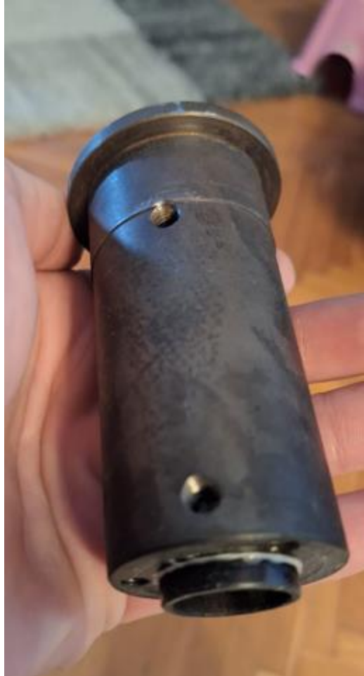
Slika 2.7 – Komora za plastiku nakon testiranja
