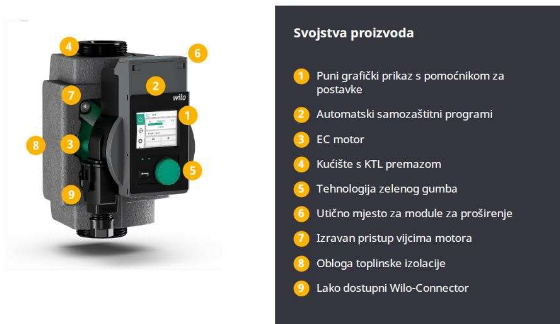
Slika 3.2.3 – Svojstva testirane crpke [3]
