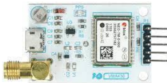
Slika 6.6. GPS modul Velleman VMA430 koji se koristi u radu. [26]
