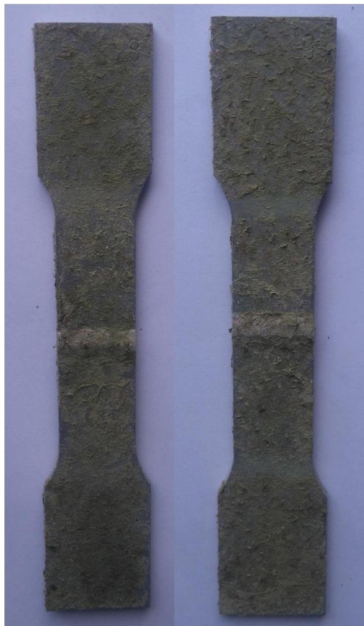
Slika 6.7 Obraštanje uzorka 9 (desno) i 11(lijevo)
