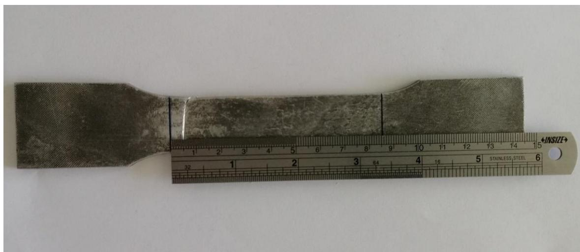
Slika 6.10 Konačno produljenje uzorka
