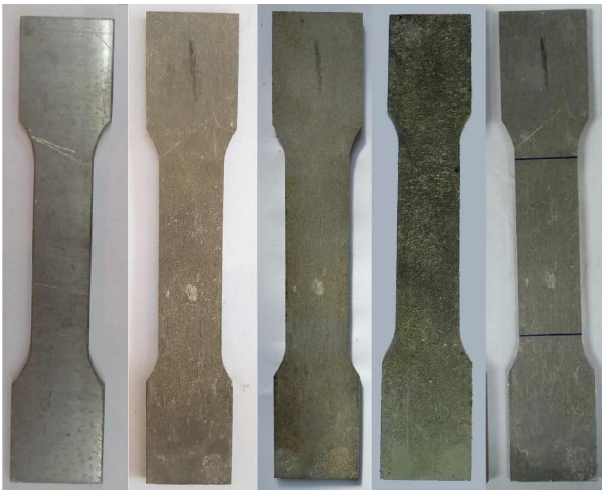
Slika 6.4 Izgled uzorka 10 prije, tijekom i nakon ispitivanja
