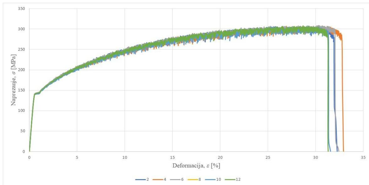
Slika 6.13 Dijagram naprezanje i deformacija ( $\sigma$ - $\epsilon$ ) nezavarenih uzoraka
