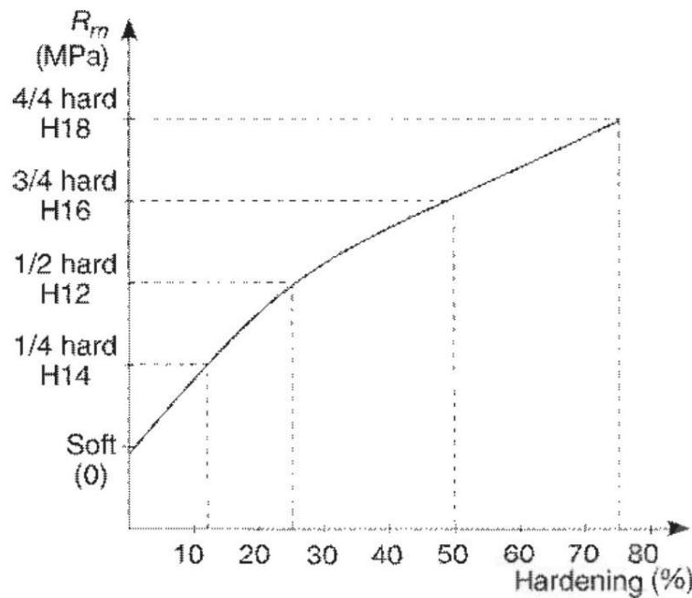
Slika 2.1 Stanje materijala ovisno o stupnju očvršćenja [6]
