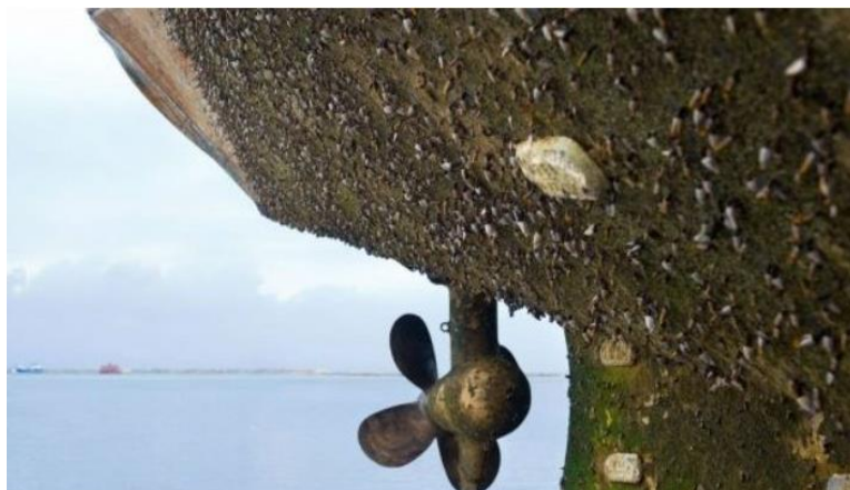
Slika 10. Primjer biokorozije – obraštaj podvodnog dijela brodskog trupa [11]
