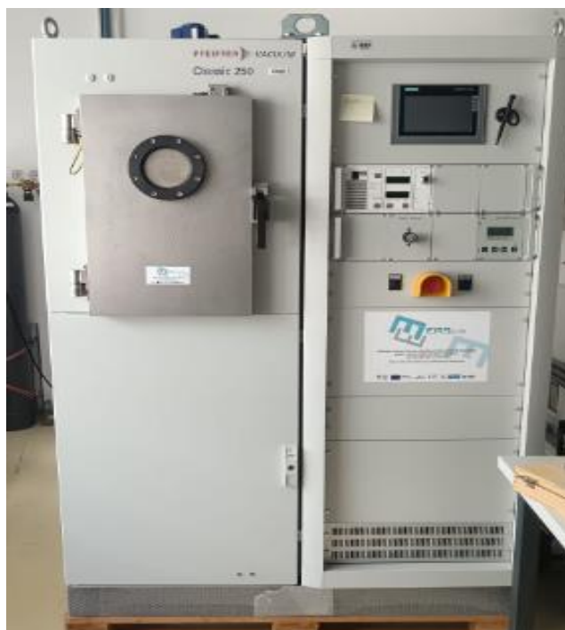
Slika 11. Uređaj za magnetronsko raspršenje [13]
