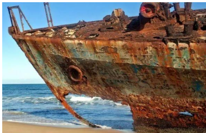
Slika 5. Korozija u okolišu morske vode [6]
