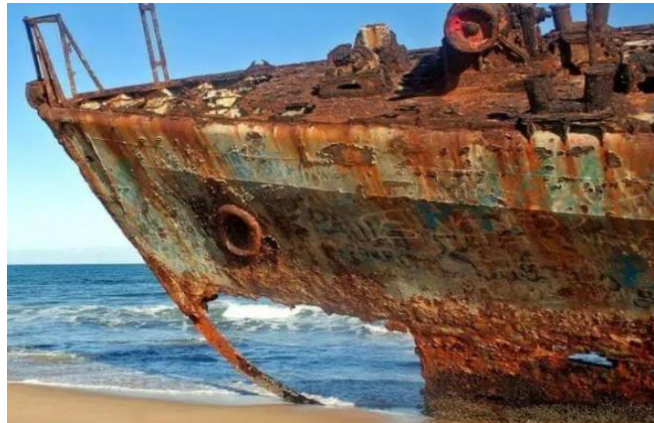
Slika 5. Korozija u okolišu morske vode [6]
