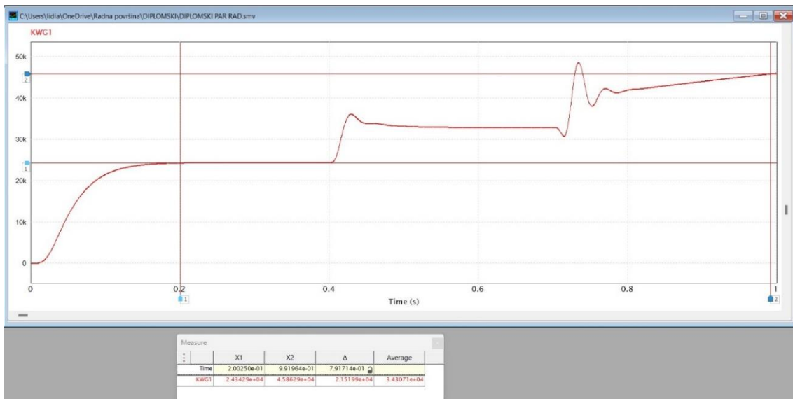
Slika 46. Djelatno opterećenje dizel generatora 1 u slučaju rada dizel generatora 2 u motorskom režimu rada. [8]
