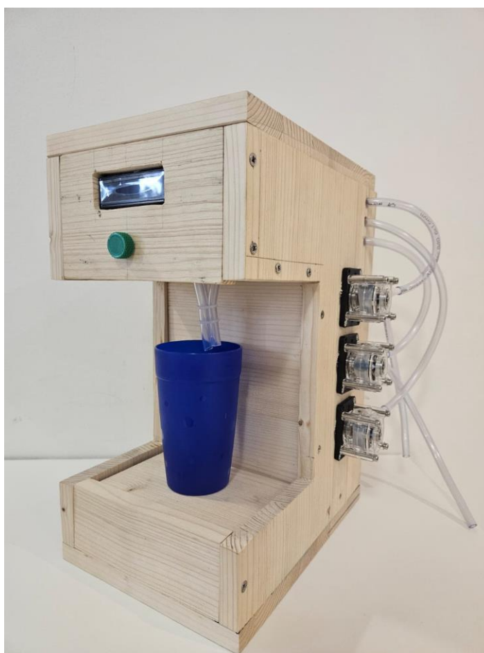
Slika 2. Gotova maketa za simulaciju automatiziranog procesa miješanja tekućina [2]
