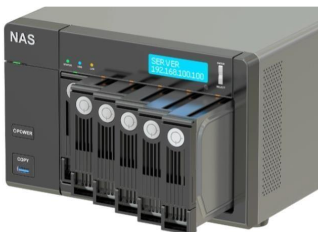
Slika 5.1 Uređaj za mrežnu pohranu (NAS)
