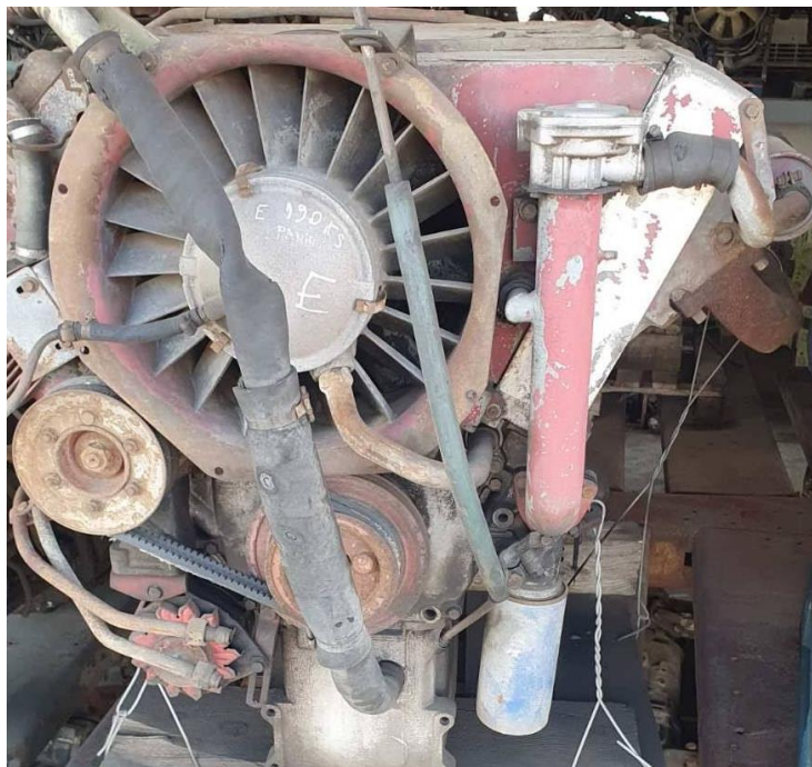
Slika 2.1- Dizelski V6 motor zračno hlađen
