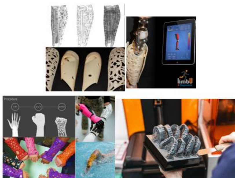
Slika 2. 16. – Modeli koju su nastali aditivnom tehnologijom, a primjenjuju se u medicini [4]
