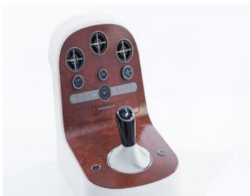
Slika 2. 28. – Središnja konzola izrađena aditivnom tehnologijom [23]
