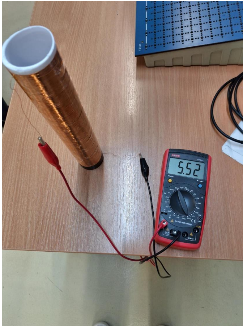
Slika 4. 3: Multimetrom izmjereni induktivitet
