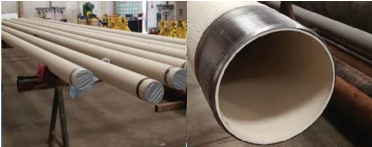
Slika 5.11 Primjer cijevi obložene poli-staklenim premazom [24]
