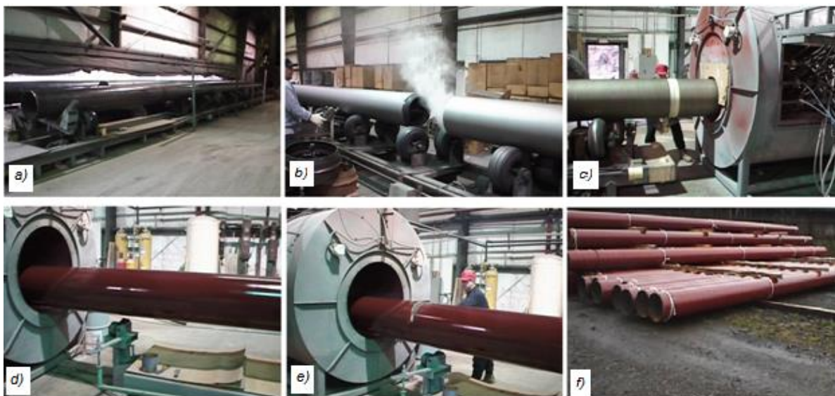
Slika 5.7 Proces proizvodnje epoksidnog premaza spojenog fuzijom; a) Cijev prije pripreme; b) Cijev nakon pripreme i ugrađivanja spojnice; c) Zaštita spoja od premaza ; d) Premaz ; e) Skidanje zaštite; f) Skladištenje [23]
