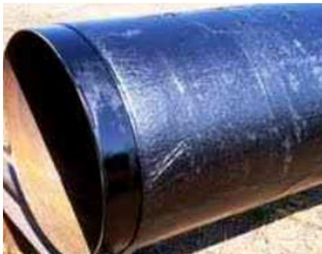
Slika 5.5.2 Cijev obložena asfaltom i katranom [21]
