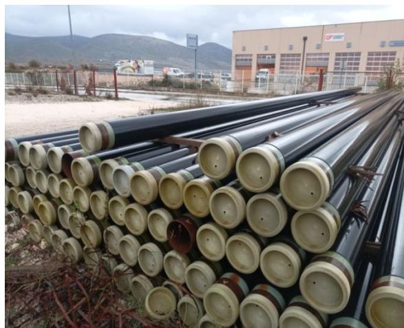
Slika 7.1 Čelične cijevi obložene 3LPE [44]
