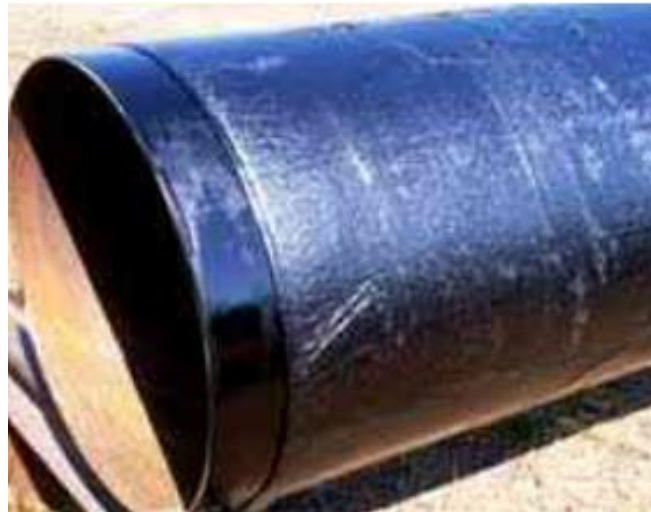
Slika 5.5.2 Cijev obložena asfaltom i katranom [21]
