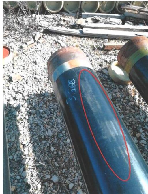
Slika 7.3 Površinsko oštećenje izolacije nastalo uslijed transporta cijevi [44]
