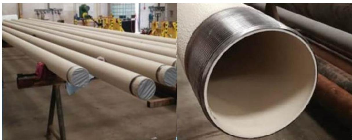
Slika 5.11 Primjer cijevi obložene poli-staklenim premazom [24]
