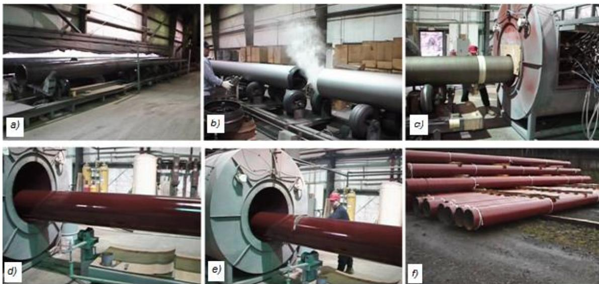
*Slika 5.7 Proces proizvodnje epoksidnog premaza spojenog fuzijom; a) Cijev prije pripreme; b) Cijev nakon pripreme i ugrađivanja spojnica; c) Zaštita spoja od premaza ; d) Premaz ; e) Skidanje zaštite; f) Skladištenje [23]*
