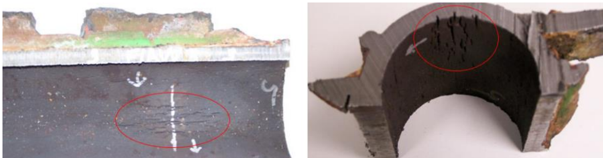
Slika 4.3 Pukotine cijevi izazvane zamorom [19]
