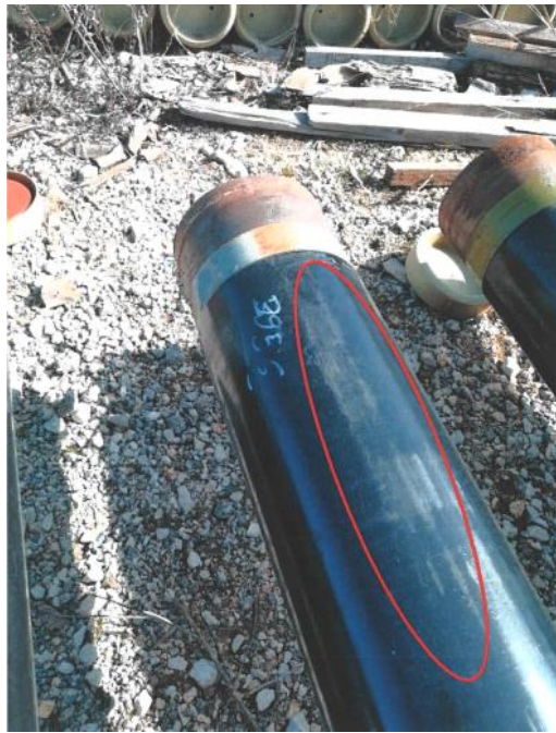
Slika 7.3 Površinsko oštećenje izolacije nastalo uslijed transporta cijevi [44]
