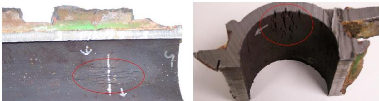
Slika 4.3 Pukotine cijevi izazvane zamorom [19]
