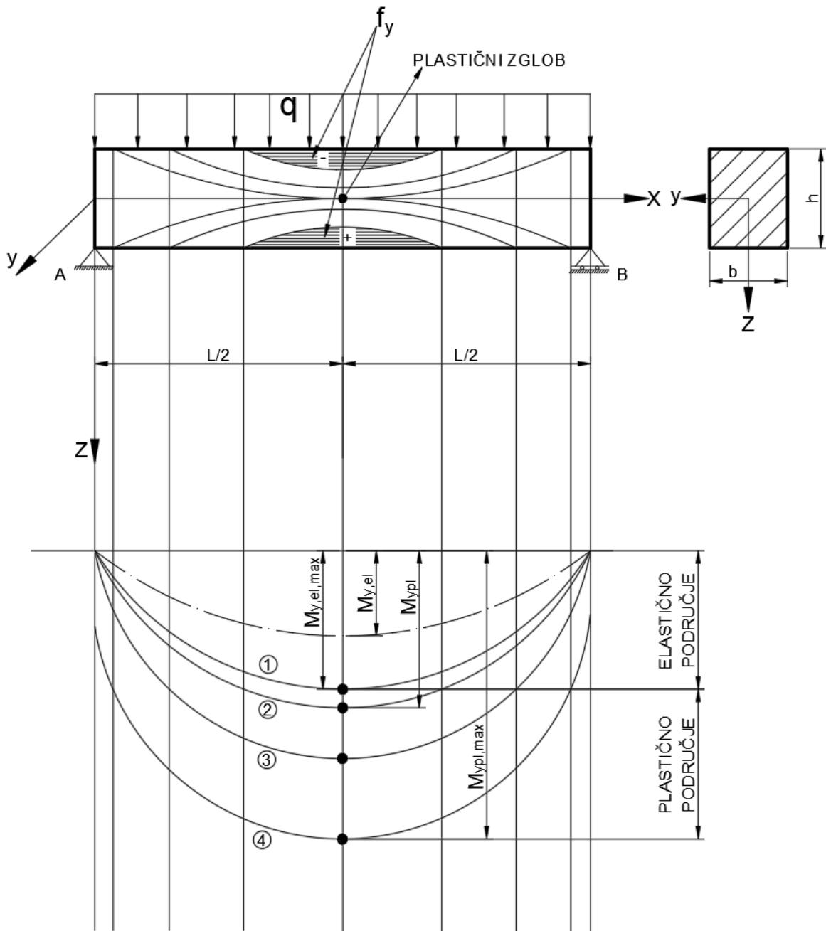
Slika 2.1 - Opterećenje nosača u elastičnom plastičnom području [5]
