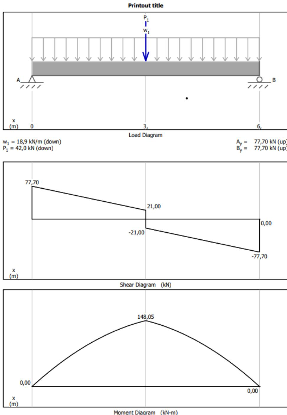
Slika 5.6 - Dobiveni dijagrami unutarnjih sila
