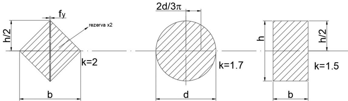
Slika 4.3 - Poprečni presjeci pravokutnog, kružnog i romba oblika [5]
