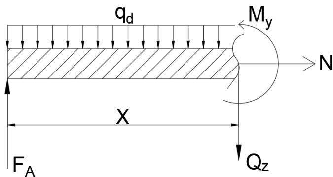
Slika 5.4 - Prikaz unutarnjih slika za  $0 < x < 3$  [5]
