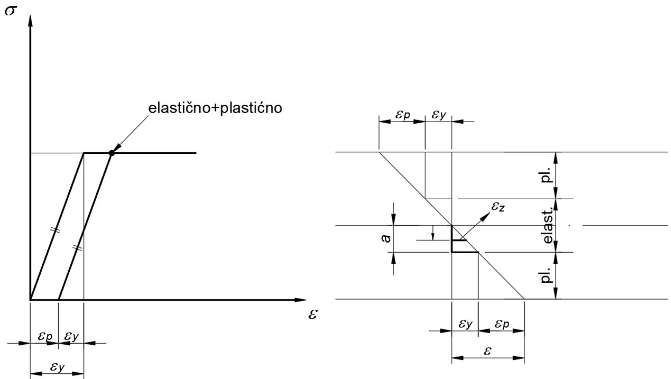
Slika 3.2 - Dijagram naprezanja i deformacija u elastično-plastičnom području [5]
