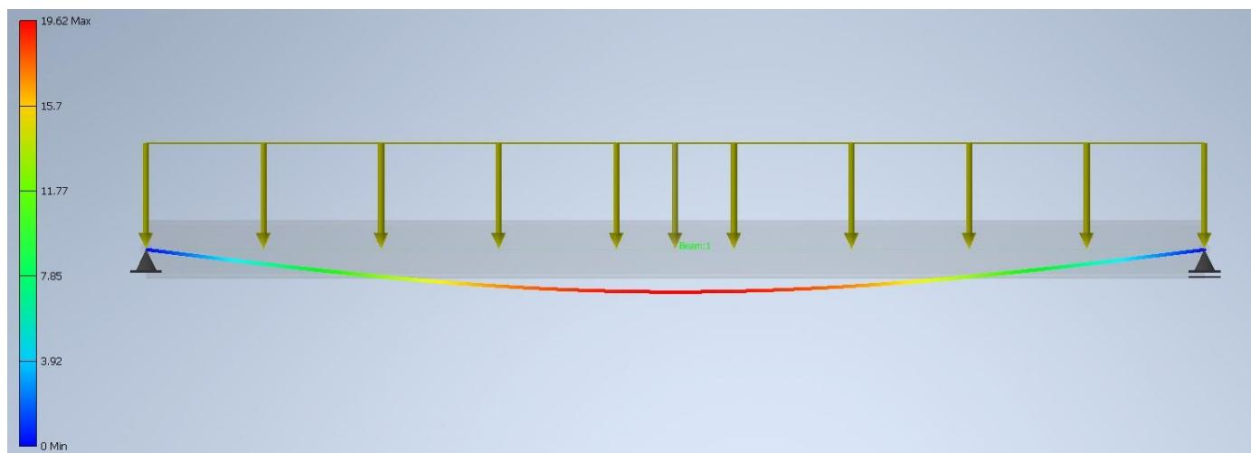
Slika 5.10 - Simulacija savijanja profila IPE 330 [6]
