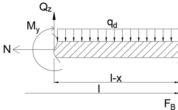
Slika 5.5 - Prikaz unutarnjih slika za  $3 < x < 6$  [5]
