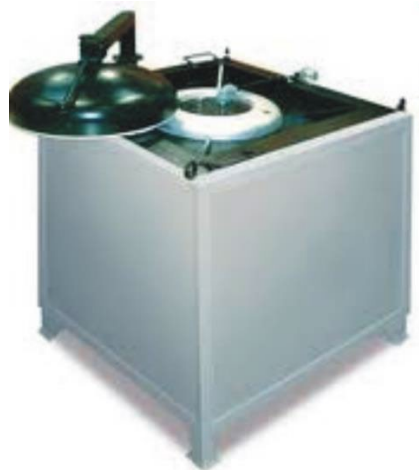
Slika 2.6 - Peć sa solnom kupkom [2]
