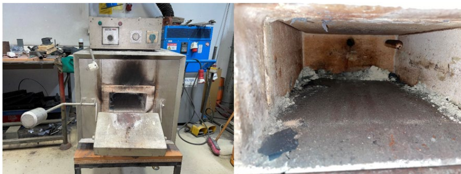
Slika 5.1 - Razmatrana peć za toplinsku obradu
