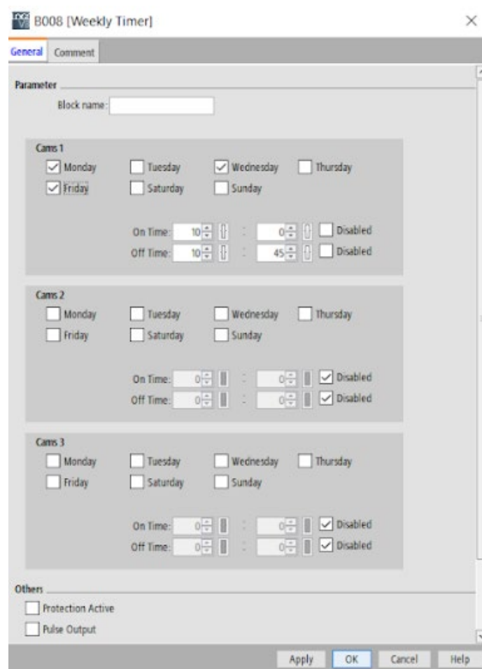
Slika 5.13 - Primjer vremenske automatizacije rada peći
