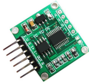
Slika 5.5 - Konverter napona termopara [10]
